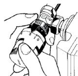
Prima di procedere all'installazione del kit termostatico, portare il selettore della testa in posizione "5", in modo da facilitare le successive operazioni di installazione.
