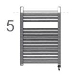
Assicurarsi che il collegamento tra lo scaldasalviette e l'elemento riscaldante sia stretto e che la guarnizione appoggi bene al montante. Forzando eccessivamente si comprometterà il funzionamento dell'apparecchio.
